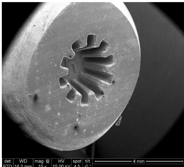
Fabrication d'une empreinte d'étampage en carbure de tungstène par procédé  $\mu$ EDM
